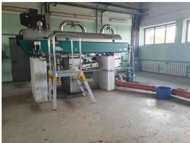
9,10 pav. Technologinė įranga išdėstyta ant bunkerio perdangos
