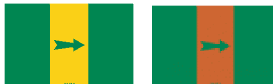
1 pav. Paduodamas ir grįžtamo vamzdynų ženklavimas
